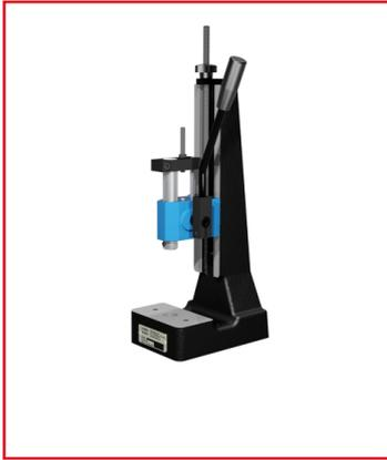
Cette presse manuelle à crémaillère Mäder transmet un effort constant sur toute la course, avec une transmission directe et contrôlée de la force. La course est ajustable grâce à une vis de réglage, et le levier ergonomique est réglable pour un confort optimal. La table de presse rectifiée, avec perçage Ø 10H7 et taraudages M8/M10, permet une fixation polyvalente. Idéale pour les opérations précises d'emmanchement et d'assemblage sur des courses longues.
