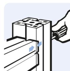
A l'aide d'une clé 6 pans de 5, visser la fixation dans le profilé taraudé en M8.
