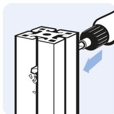
Réaliser un perçage  $\varnothing 7$  à l'endroit souhaité.
